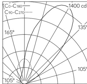
LED 3000 K 18.7 W 1549 lm-h / CIE Flux 0 0 25 0 100 / E84 nach DIN 5040
