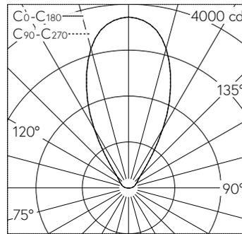
LED 3000 K 35.3 W 3292 lm-h / CIE Flux 0 0 10 1 100 / E04 nach DIN 5040
