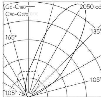
LED 3000 K 18 W 1729 lm-h / CIE Flux 0 0 0 100 / E84 nach DIN 5040
