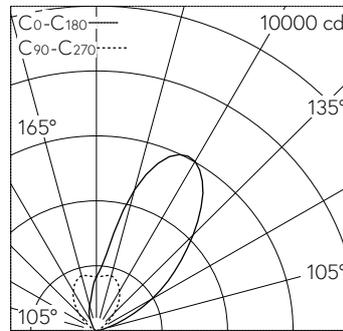
LED 3000 K 50 W 5359 lm-h / CIE Flux 0 0 0 100 / E84 nach DIN 5040
