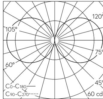
LED 3000 K 5 W 463 lm-h / CIE Flux 13 37 66 50 100 / C11 nach DIN 5040
