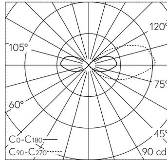
LED 3000 K 9.5 W 169 lm-h / CIE Flux 2 18 50 45 100 / C11 nach DIN 5040
