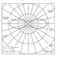
LED 3000 K 9.5 W 355 lm-h / CIE Flux 1 16 50 50 100 / C11 nach DIN 5040
