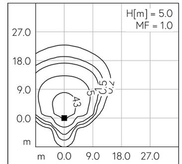
LED 3000 K 58.5 W 7059 lm-h H = 5 m / CIE Flux 39 80 99 100 100 / A30 nach DIN...
