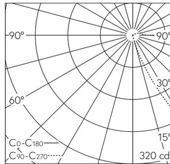
LED 4000 K 4 W 410 lm-h / CIE Flux 18 51 83 96 100 / A11 nach DIN 5040
