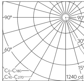
LED 3000 K 13.5 W 1113 lm-h / CIE Flux 25 71 94 100 100 / A20 nach DIN 5040
