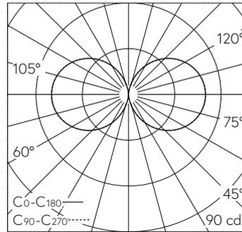
LED 4000 K 5 W 475 lm-h / CIE Flux 13 37 66 50 100 / C11 nach DIN 5040
