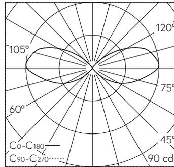
LED 3000 K 5 W 91 / CIE Flux 2 18 50 45 100 / C11 nach DIN 5040
