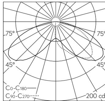
LED 3000 K 5 W 371 lm-h / CIE Flux 28 69 94 100 100 / A20 nach DIN 5040
