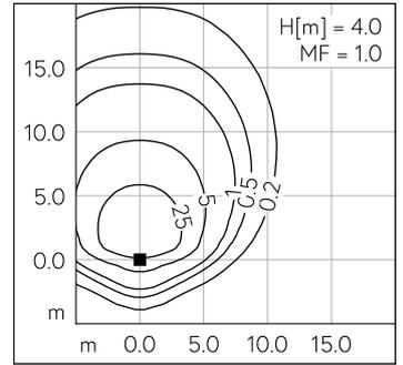
LED 3000 K 26.6 W 2582 lm-h H = 5 m / CIE Flux 43 81 97 100 100 / A40 nach DIN ...
