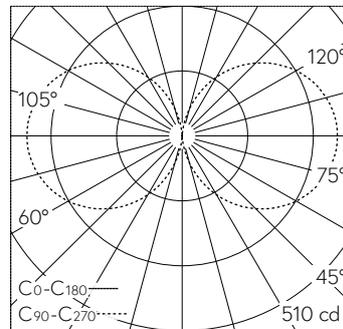
LED 3000 K 35.7 W 2294 lm-h / CIE Flux 13 37 66 50 100 / C11 nach DIN 5040
