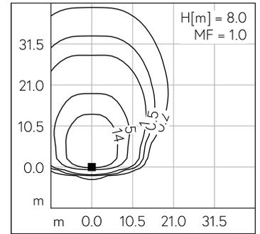
LED 4000 K 51 W 7914 lm-h H = 8 m / CIE Flux 37 74 96 100 100 / A30 nach DIN 50...
