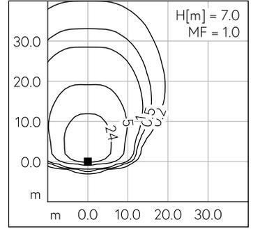
LED 4000 K 67 W 10515 lm-h H = 9 m / CIE Flux 37 74 96 100 100 / A30 nach DIN 5...
