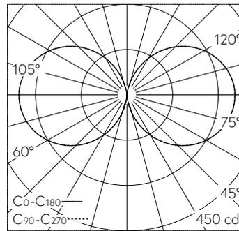
LED 4000 K 35.2 W 3331 lm-h / CIE Flux 13 37 66 51 100 / C11 nach DIN 5040
