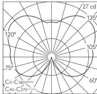
LED 3000 K 3.8 W 351 lm-h 274°/274° / CIE Flux 10 35 65 40 100 / C12 nach DIN 5...
