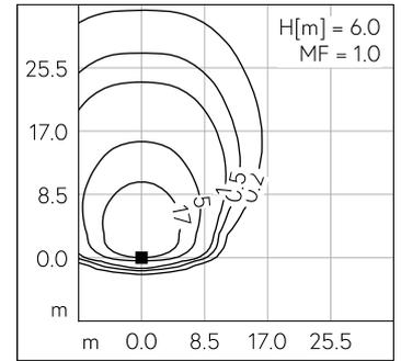
LED 4000 K 34.5 W 5138 lm-h H = 6 m / CIE Flux 35 72 95 100 100 / A30 nach DIN ...
