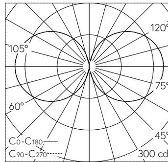
LED 4000 K 25.5 W 2553 lm-h 230°/230° / CIE Flux 12 37 66 50 100 / C11 nach DIN...
