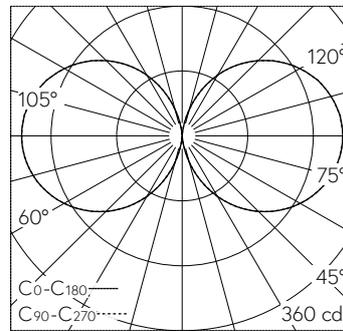
LED 4000 K 35.5 W 3259 lm-h 236°/236° / CIE Flux 12 37 66 50 100 / C11 nach DIN...
