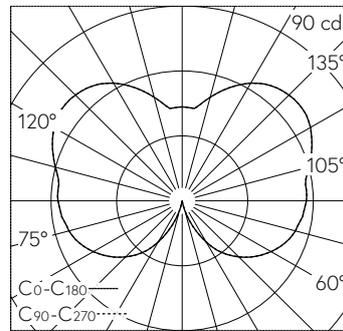
LED 3000 K 9.2 W 822 lm-h 274°/274° / CIE Flux 10 35 65 40 100 / C12 nach DIN 5...
