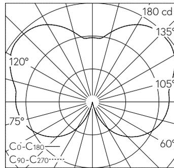
LED 4000 K 18 W 1829 lm-h 272°/272° / CIE Flux 11 35 65 40 100 / C12 nach DIN 5...
