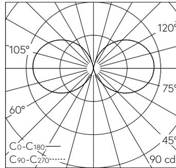
LED 4000 K 7 W 492 lm-h 126° / CIE Flux 10 33 63 48 100 / C11 nach DIN 5040
