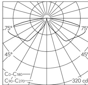
LED 4000 K 28 W 798 lm-h 70°/70° / CIE Flux 15 47 82 99 100 / A10 nach DIN 5040
