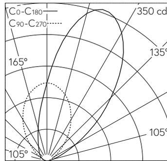
LED 3000 K 5.1 W 419 lm-h / CIE Flux 0 0 0 100 / E84 nach DIN 5040
