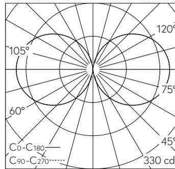
LED 3000 K 17.3 W 2390 lm-h / CIE Flux 13 37 66 50 100 / C11 nach DIN 5040
