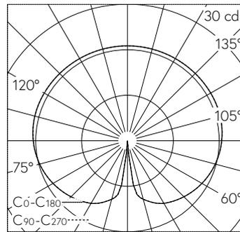
LED 3000 K 2.9 W 245 lm-h / CIE Flux 21 45 71 46 100 / C12 nach DIN 5040
