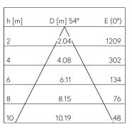
LED 4000 K 40 W 3890 lm-h 56° / CIE Flux 96 100 100 100 100 / A80 nach DIN 5040
