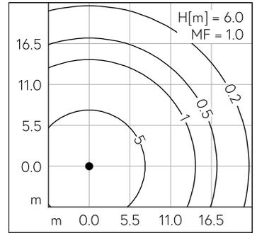
LED 3000 K 28 W 3269 lm-h 148° H = 4.5 m / CIE Flux 31 66 93 100 100 / A20 nach ...
