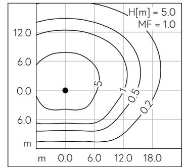
LED 3000 K 28 W 2658 lm-h H = 5 m / CIE Flux 39 73 94 100 100 / A30 nach DIN 5...
