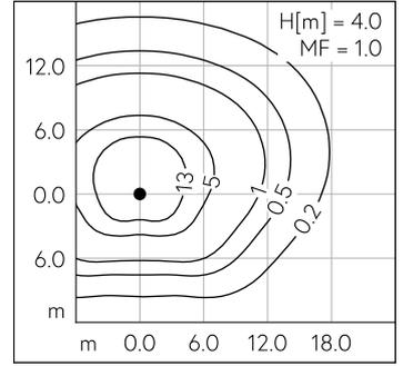
LED 4000 K 28 W 2792 lm-h H = 5 m / CIE Flux 39 73 94 100 100 / A30 nach DIN 5...
