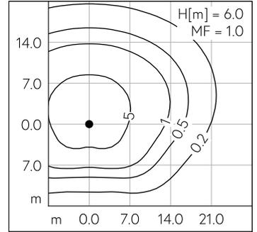
LED 4000 K 28 W 2792 lm-h H = 4.5 m / CIE Flux 39 73 94 100 100 / A30 nach DIN ...
