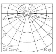
LED 3000 K 9 W 780 lm-h / CIE Flux 5 21 50 93 100 / A11 nach DIN 5040
