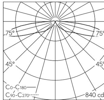
LED 4000 K 15 W 1598 lm-h / CIE Flux 5 23 64 95 100 / A11 nach DIN 5040
