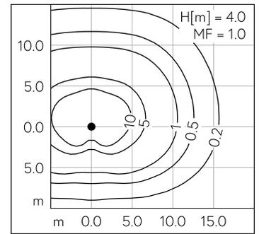
LED 4000 K 18.3 W 1970 lm-h H = 4 m / CIE Flux 39 74 95 100 100 / A30 nach DIN ...
