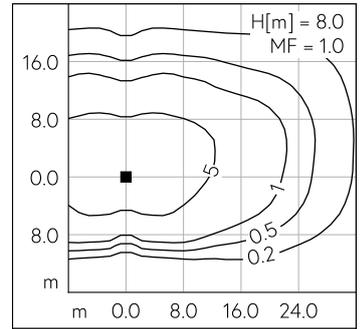
LED 4000 K 34.5 W 4882 lm-h H = 7 m / CIE Flux 38 75 96 100 100 / A30 nach DIN ...
