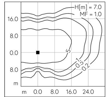
LED 4000 K 53 W 7770 lm-h H = 7 m / CIE Flux 33 71 97 100 100 / A20 nach DIN 50...
