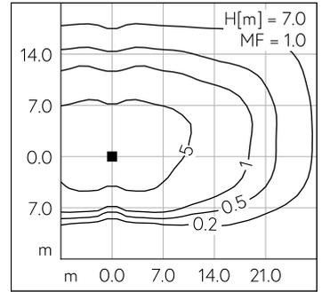
LED 3000 K 52 W 7170 lm-h H = 6 m / CIE Flux 38 75 96 100 100 / A30 nach DIN 5...
