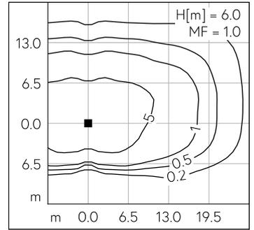
LED 4000 K 52 W 7376 lm-h H = 5 m / CIE Flux 38 75 96 100 100 / A30 nach DIN 5...
