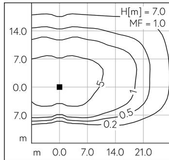
LED 4000 K 52 W 7376 lm-h H = 7 m / CIE Flux 38 75 96 100 100 / A30 nach DIN 5...
