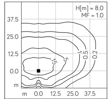
LED 3000 K 206 W 28914 lm-h H = 8 m / CIE Flux 32 65 92 100 100 / A20 nach DIN...
