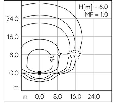
LED 4000 K 69 W 10270 lm-h H = 5 m / CIE Flux 31 69 95 100 100 / A20 nach DIN 5...
