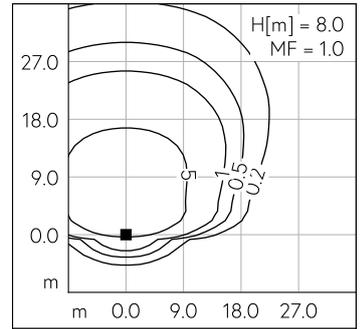
LED 4000 K 69 W 10270 lm-h H = 7 m / CIE Flux 31 69 95 100 100 / A20 nach DIN 5...
