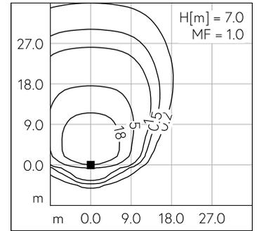
LED 4000 K 106 W 14534 lm-h H = 7 m / CIE Flux 35 73 96 100 100 / A30 nach DIN ...
