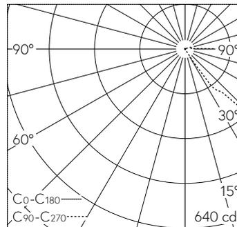
LED 3000 K 5.4 W 424 lm-h / CIE Flux 4 35 74 97 100 / A10 nach DIN 5040
