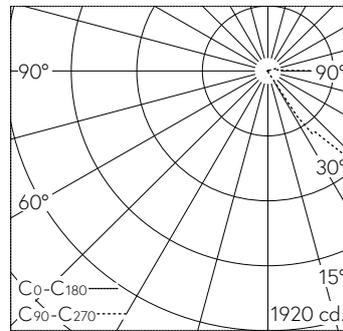
LED 4000 K 14.7 W 1393 lm-h / CIE Flux 5 36 75 97 100 / A10 nach DIN 5040
