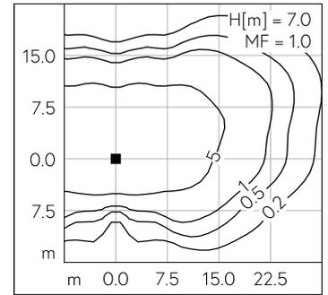
LED 3000 K 53 W 7553 lm-h H = 7 m / CIE Flux 33 72 98 100 100 / A20 nach DIN 5...
