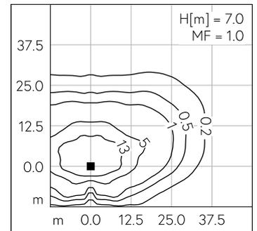
LED 4000 K 67 W 9885 lm-h H = 7 m / CIE Flux 33 67 93 100 100 / A20 nach DIN 5...
