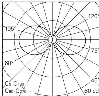
LED 4000 K 7 W 415 lm-h / CIE Flux 12 36 66 52 100 / C11 nach DIN 5040
