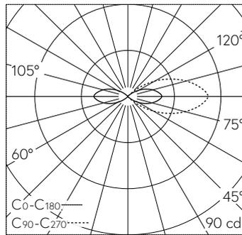
LED 4000 K 7 W 120 lm-h / CIE Flux 1 11 44 49 100 / C11 nach DIN 5040
