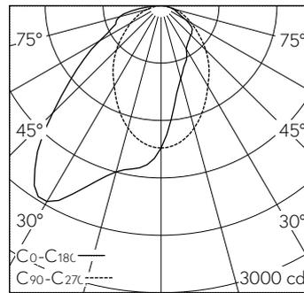
LED 4000 K 32 W 3800 lm-h / CIE Flux 51 81 95 100 100 / A40 nach DIN 5040
